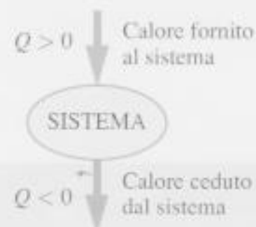
figura 6 Convenzione per il segno del calore
